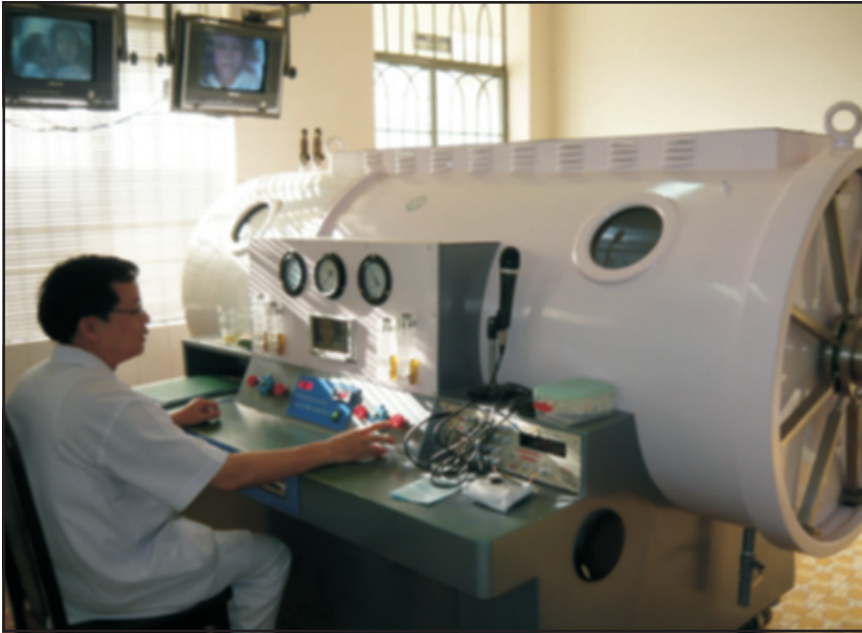
Theo dõi và điều tiết lượng oxy khi có bệnh nhân nằm điều trị trong máy oxy cao áp
