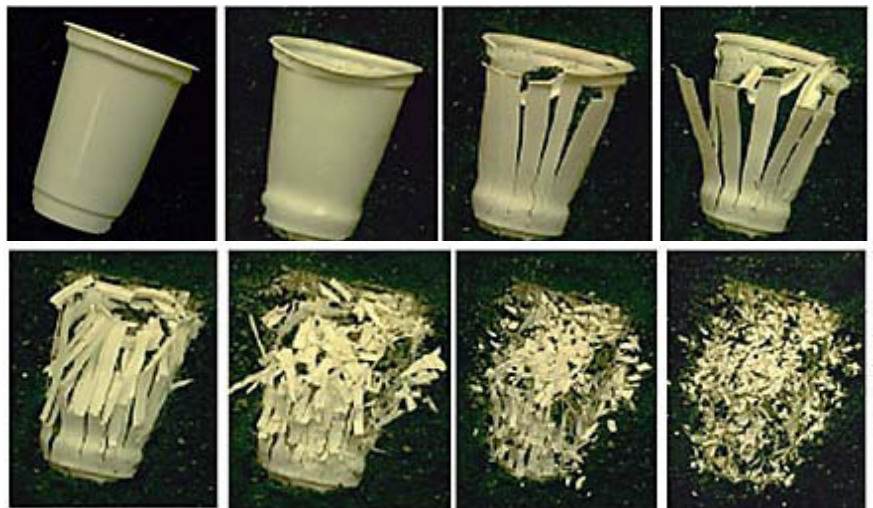
Sản phẩm bằng nhựa PLA (Cargill) làm từ bột bắp phân hủy trong 45 ngày
