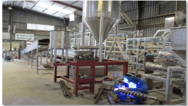
Dây chuyền sản xuất nui của Liduta đang trong giai đoạn hoàn thiện.
