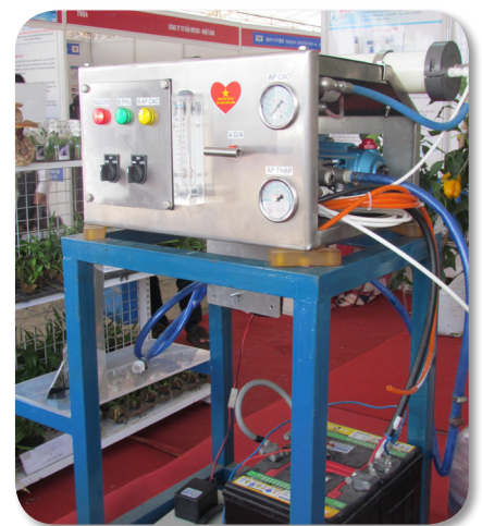
Thiết bị lọc nước biển được giới thiệu tại Tech Demo 2015. Ảnh: LV.
