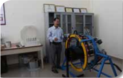
Ông Nguyễn Hữu Quang giới thiệu máy chụp cắt lớp điện toán công nghiệp (GORBIT) do CANTI chế tạo. Ảnh: LV.
