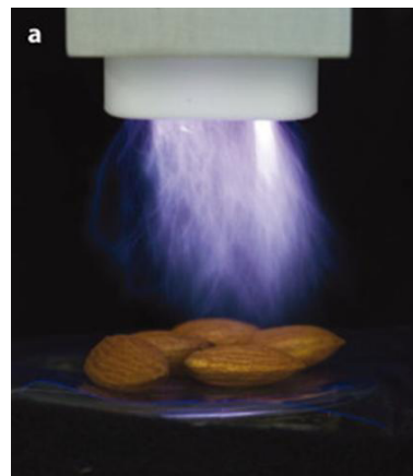
Xử lý E.coli được tiêm vào hạt hạnh nhân bằng Plasma Jet. Nguồn: Niemira BA. 2012.
