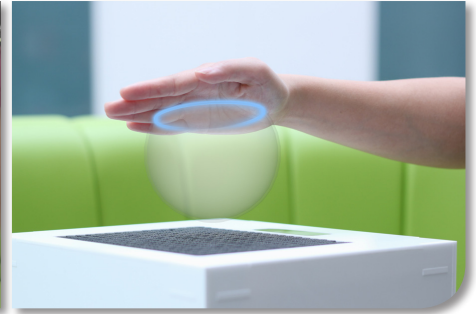
Công nghệ haptic của Đại học Bristol: dùng sóng siêu âm tạo vật thể 3 chiều có thể nhìn và cảm nhận được.
