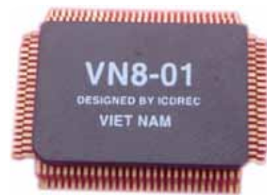
Chip thương mại 8-bit sản xuất tại Trung tâm Nghiên cứu và Đào tạo Thiết kế vi mạch ĐHQG TP. HCM.
