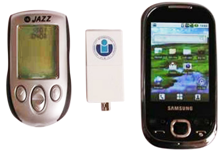
Thiết bị ghép nối đo đường từ xa mẫu do Bộ môn Bộ môn Kỹ thuật Y sinh phát triển và chế tạo (giữa) giúp kết nối qua Bluetooth máy đo đường trong máu hiện có trên thị trường (trái) và điện thoại di động thông minh (smart phone) (phải).
