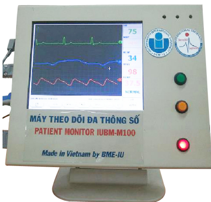
Máy theo dõi đa thông số được đặt tại giường bệnh nhân để liên tục theo dõi các chỉ số nhịp tim HR, SPO 2 , nhịp thở RESP, nhiệt độ TEMP, huyết áp SYST và DIAS. Trên màn hình LCD hiển thị 4 trong 8 kênh ECG I, II, III, aVL, aVR, aVF, SPO 2 , RESP.
