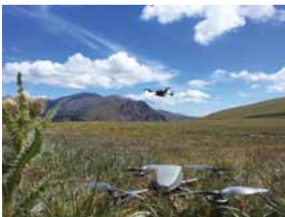
InstantEye, thiết kế của công ty PSI với những bộ phận hấp thụ va đập nhái theo cấu trúc cơ thể của ruồi.
