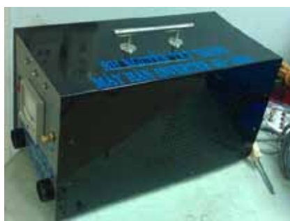
Máy hàn inverter do nhóm nghiên cứu chế tạo
