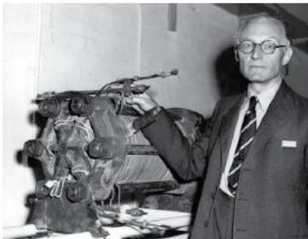
Francis Thomas Bacon phát triển các tế bào nhiên liệu đầu tiên sử dụng hydro, oxy, chất điện phân kiềm và các điện cực niken. Thiết bị được ông đặt tên là "Cell Bacon".
