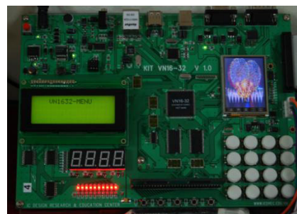
Ứng dụng chip 32-bit VN1632 vào sản phẩm khung ảnh kỹ thuật số
