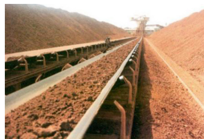
Một dây chuyền chuyên chuyên bauxit thô về trung tâm tuyến rửa
