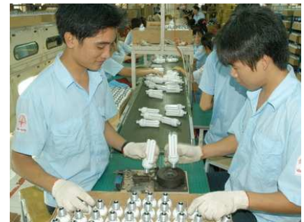
Dây chuyền sản xuất bóng đèn compact tiết kiệm năng lượng của Công ty Cổ phần bóng đèn Điện Quang
