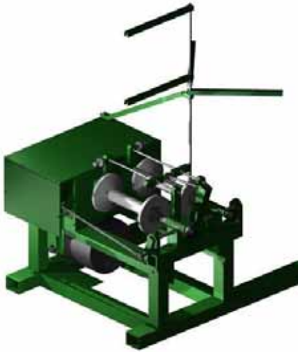
Cơ cấu đánh ống (Bobbin Winder), giúp quấn dây lên ống.
