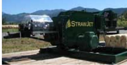
Máy bện dây (Cable Machine) để sản xuất dây thừng. Dây là phần cốt lõi trong hệ thống StrawJet.
